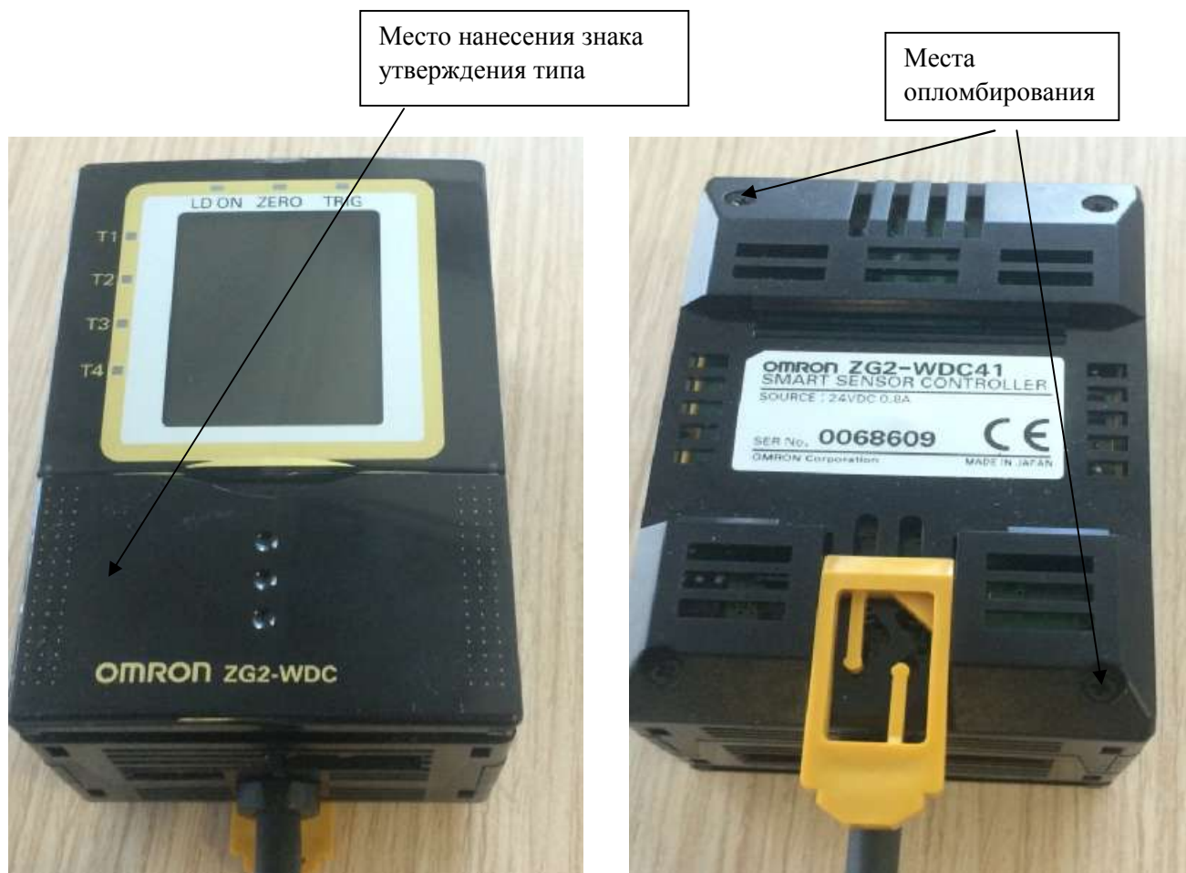
Рисунок 2 - Общий вид блока обработки информации модели ZG2-WDC, модификации ZG2-WDC41
