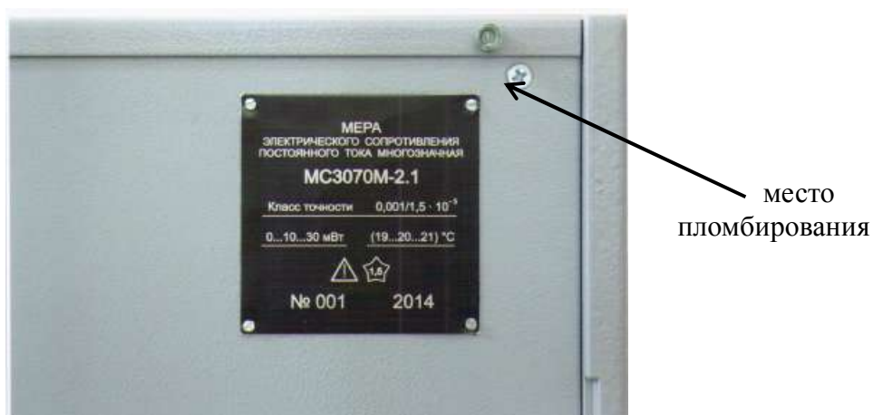
Рисунок 3 - Фотография обратной стороны мер электрического сопротивления постоянного тока многозначных МС 3070М-2.1
