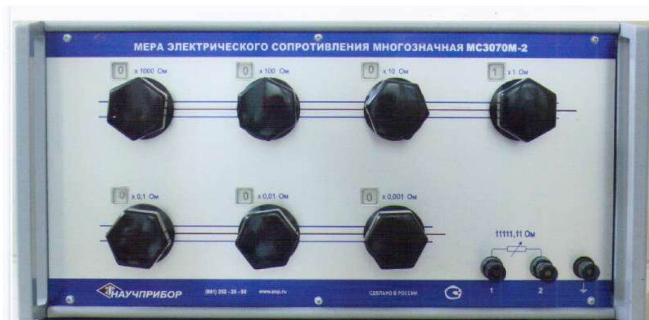
Рисунок 2 - Фотография общего вида мер электрического сопротивления постоянного тока многозначных МС 3070М-2
