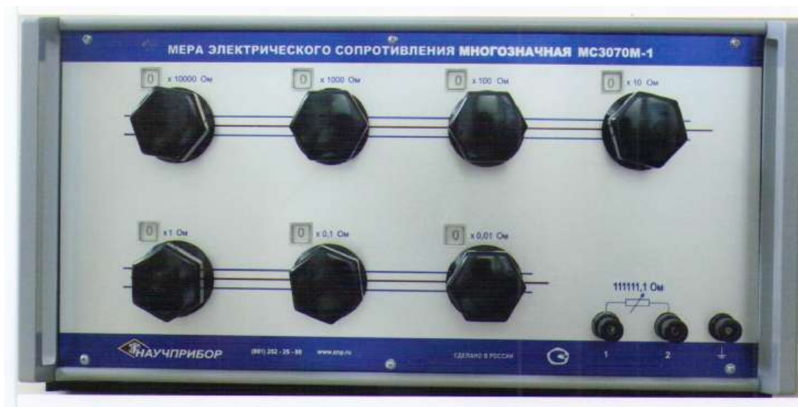
Рисунок 1 - Фотография общего вида мер электрического сопротивления постоянного тока многозначных МС 3070М-1
