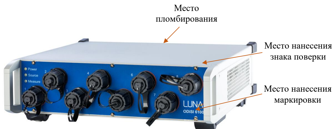
Рисунок 1 – Общий вид систем, схема пломбировки от несанкционированного доступа, обозначения мест нанесения маркировки и знака поверки
