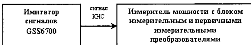
Рисунок 3 – Схема измерений для определения погрешности установки уровня мощности выходных сигналов
