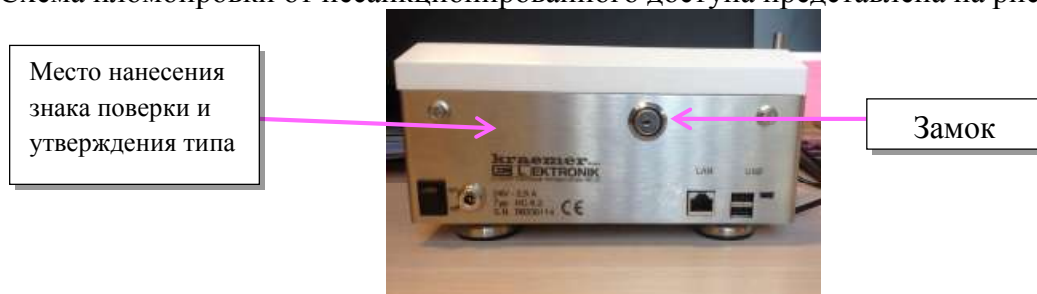
Рисунок 5 - Схема пломбировки от несанкционированного доступа
