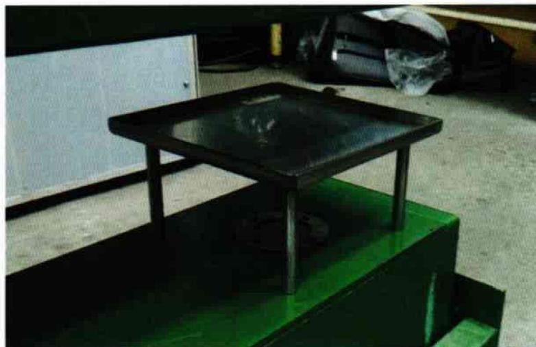
Рисунок 1 - Подставка с контрольным образцом на измерительной позиции.
