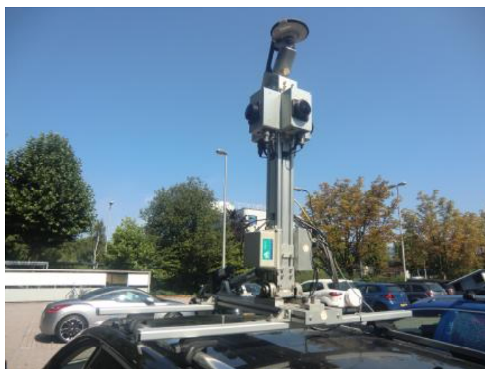
Рисунок 1 - Измерительный блок, установленный на крыше автомобиля
