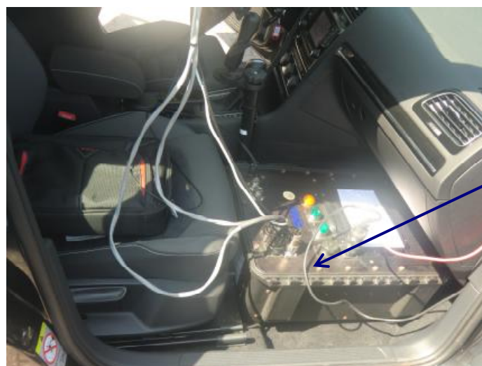
Рисунок 2 - Блок управления, установленный на месте переднего пассажира
