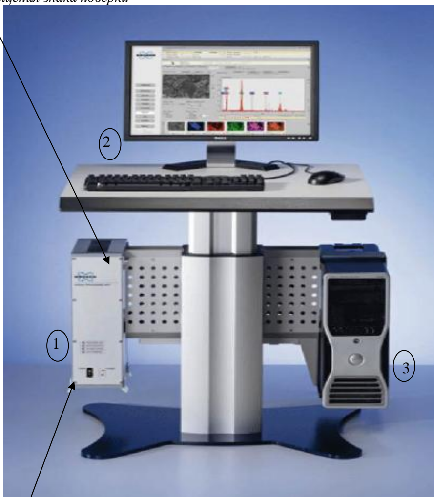
Рисунок 1 - Общий вид системы Quantax EDS без детектора 1 - блока обработки сигнала (электронный блок) системы; 2 - монитор серверного компьютера; 3 - системный блок серверного компьютера
