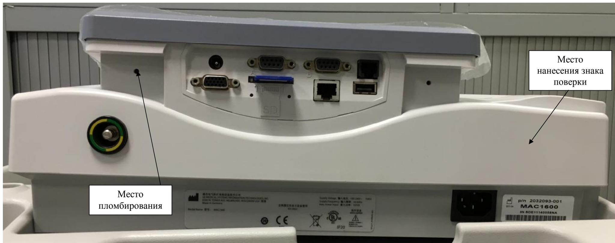
Рис. 2. Место пломбирования и место нанесения знака поверки электрокардиографов MAC 1600
