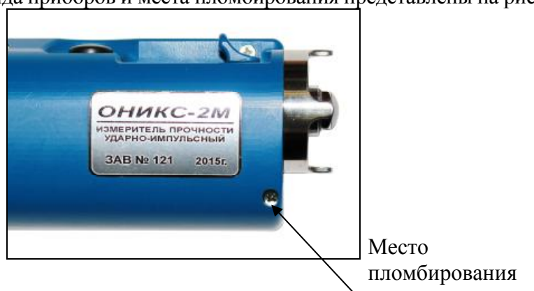
Рисунок 1 - Место пломбирования и клеймения приборов модификации Оникс-2М
