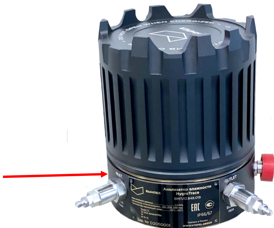
Рисунок 1 – Общий вид анализатора влажности HygroTrace, место нанесения знака поверки
