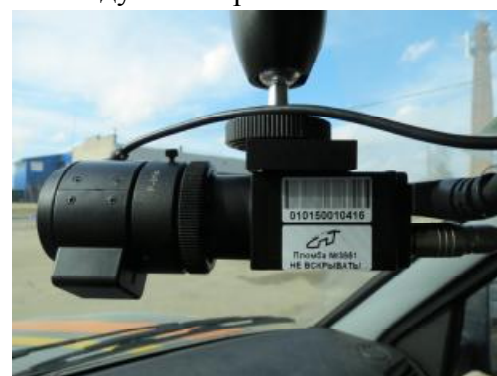
Рисунок 4 - Внешний вид видеомодуля с местом пломбировки
