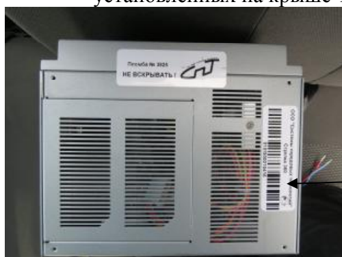
Рисунок 3 - Внешний вид модуля управления с местами нанесения знака утверждения типа и пломбировки
