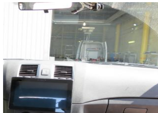
Рисунок 2 - Внешний вид видеомодуля и модуля отображения
