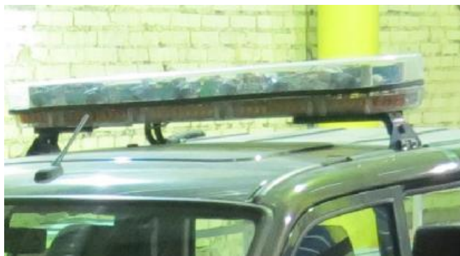
Рисунок 1 - Внешний вид видеомодулей, установленных на крыше ТС
