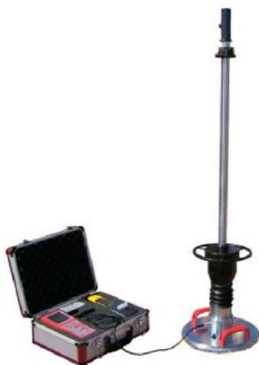
Рисунок 1 - Измеритель динамического модуля упругости грунтов серии LFG
