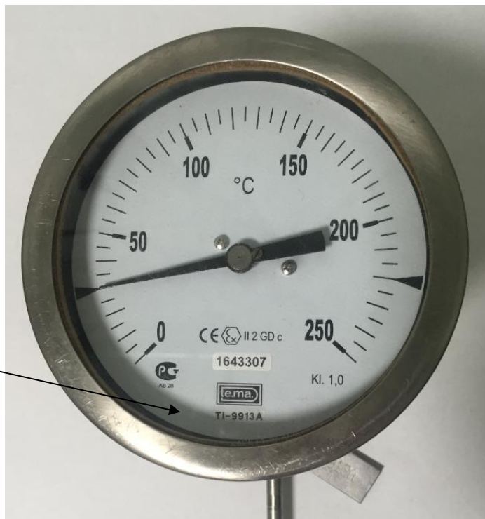
Рисунок 1 - Внешний вид термометров манометрических ТМ809 с указанием места нанесения знака поверки
