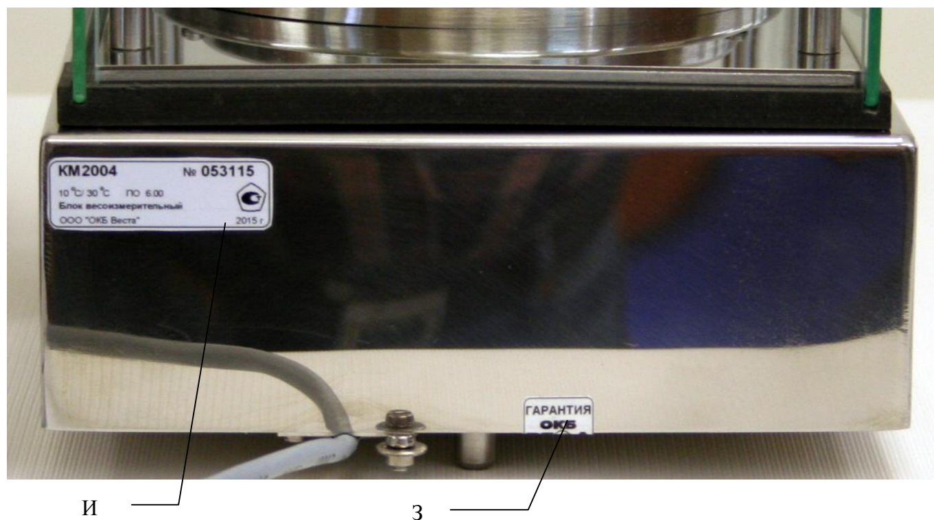
Рисунок 3 - Расположение табличек с маркировкой и защитной наклейки на весоизмерительном блоке
