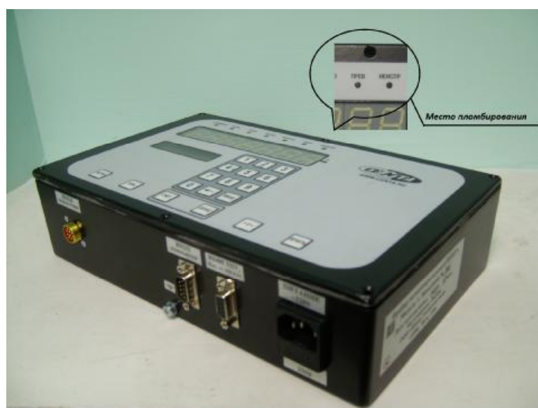
Рисунок 3 - Место пломбирования индикатора ЦЕНТА
