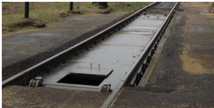
Рисунок 1 - Общий вид весов МВВ
