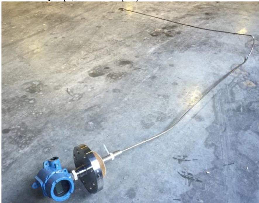
Рисунок 1 – Общий вид преобразователя термоэлектрического с унифицированным выходным сигналом FPN/644НАИ1J5M5F5Q4
