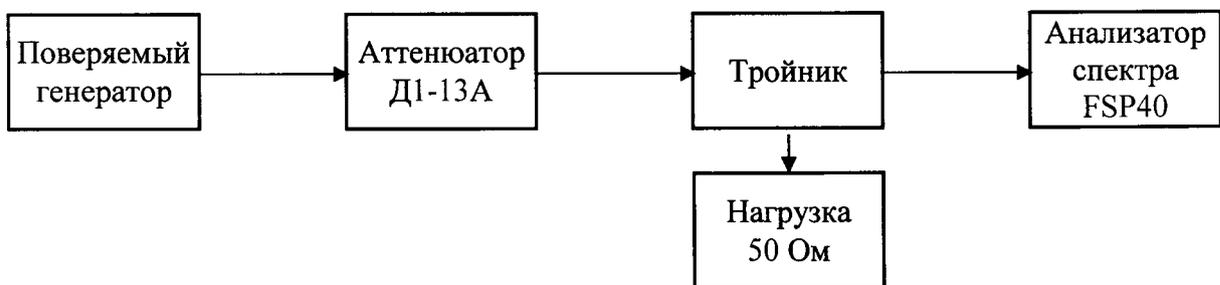
Рисунок 1 - Структурная схема подключения приборов для определения погрешности аттенюатора на частоте 30 МГц
