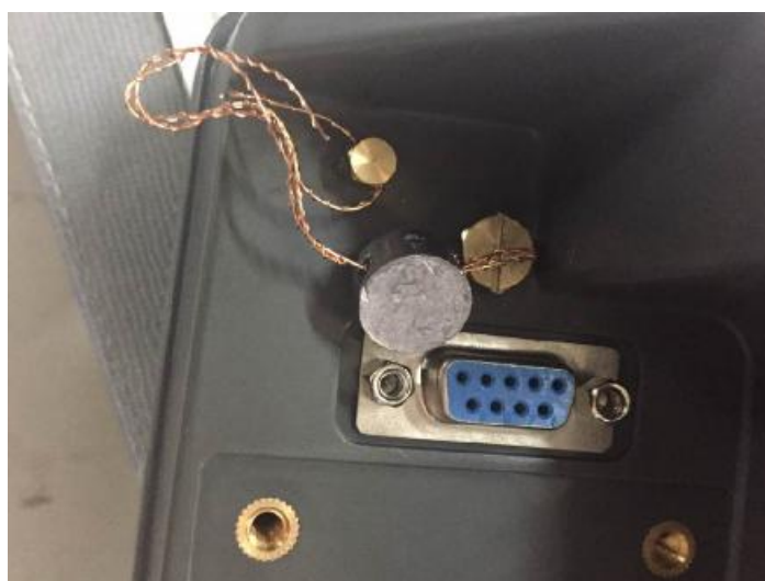
Рисунок 2 – Место пломбировки весов
