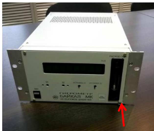
Рисунок 1. Схема пломбирования Гигрометра БАЙКАЛ МК однокорпусного.
