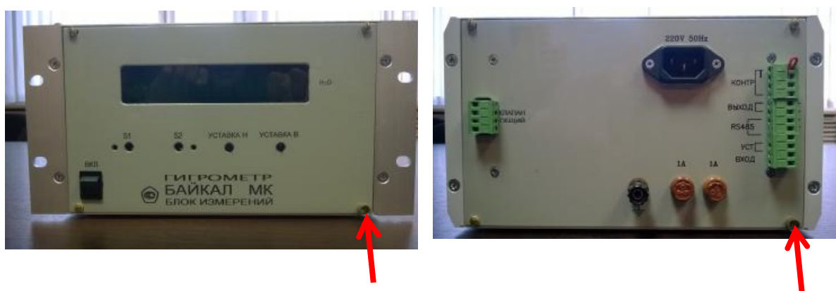
Рисунок 2. Схема пломбирования Гигрометра БАЙКАЛ МК двухкорпусного.
