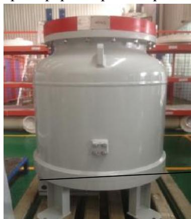
Плотность элегаза в баке контролируется монитором плотности. Для обеспечения безопасности предусмотрен предохранительный клапан с разрывной мембраной. Выводы вторичных обмоток подключены к клеммам контактной коробки, которая расположена на торце корпуса трансформатора. Крышка контактной коробки пломбируется для предотвращения несанкционированного доступа.
