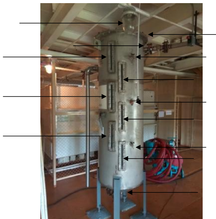
Рисунок 1 - Общий вид и места пломбирования мерника
