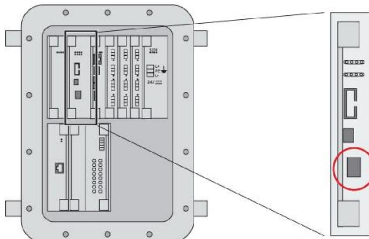
Рисунок 3 - Расположение переключателя блокировки
