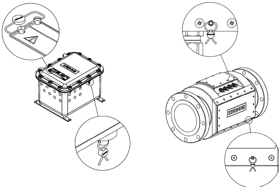
Рисунок 2 - Схема пломбирования счетчиков ALTOSONIC 5
