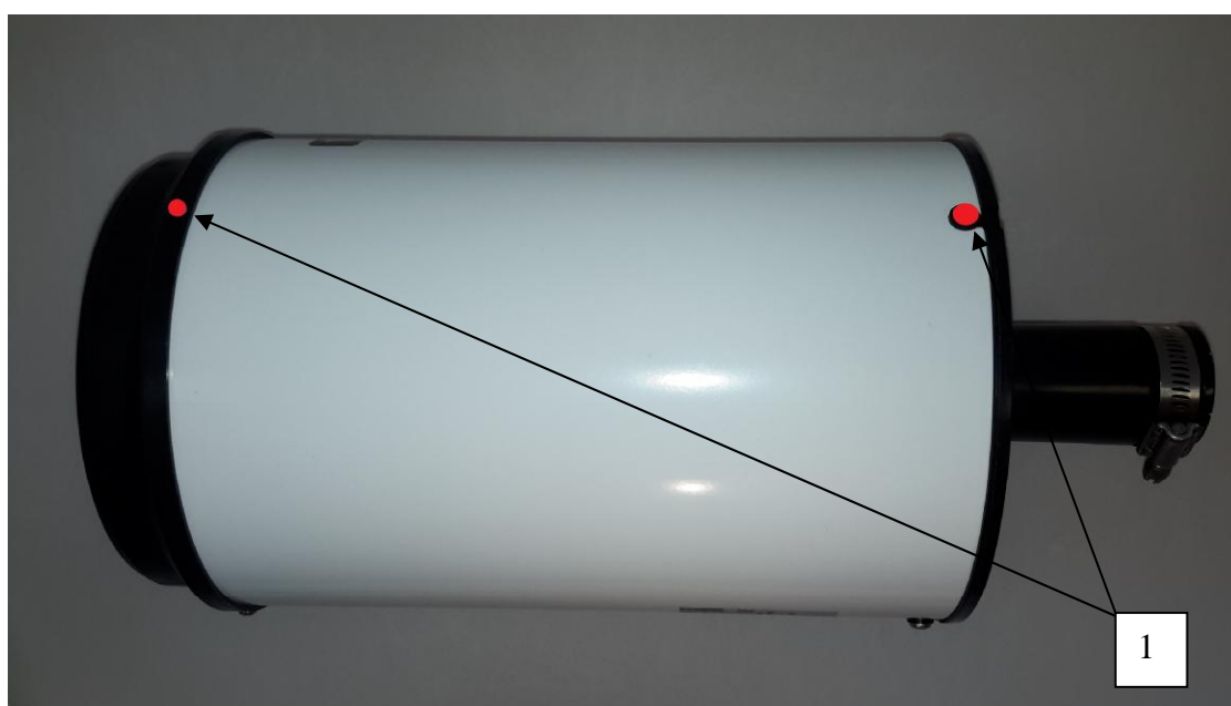
Рисунок 2 - Схема пломбирования осадкомеров МПДО-500 1 - пломбы на корпусе.
