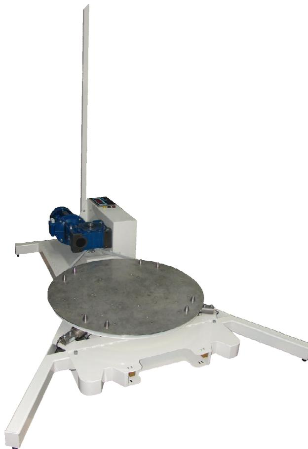
Рисунок 3 - Общий вид поворотного устройства с электродвигателем и устройством весоизмерительным
