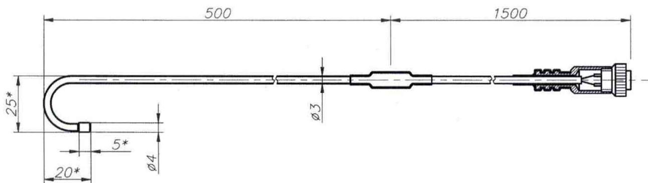
Рисунок 1 – термопреобразователь сопротивления платиновый технический (ТС2)
