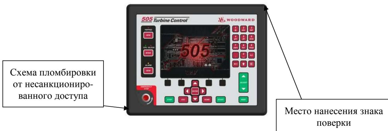
Рисунок 1 - Общий вид контроллеров, схема пломбировки от несанкционированного доступа и обозначение места нанесения знака поверки
