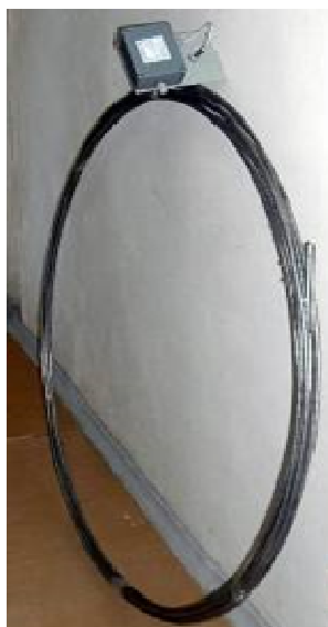
Рисунок 1 - Общий вид термогирлянды Тг-ХХ-УУ
