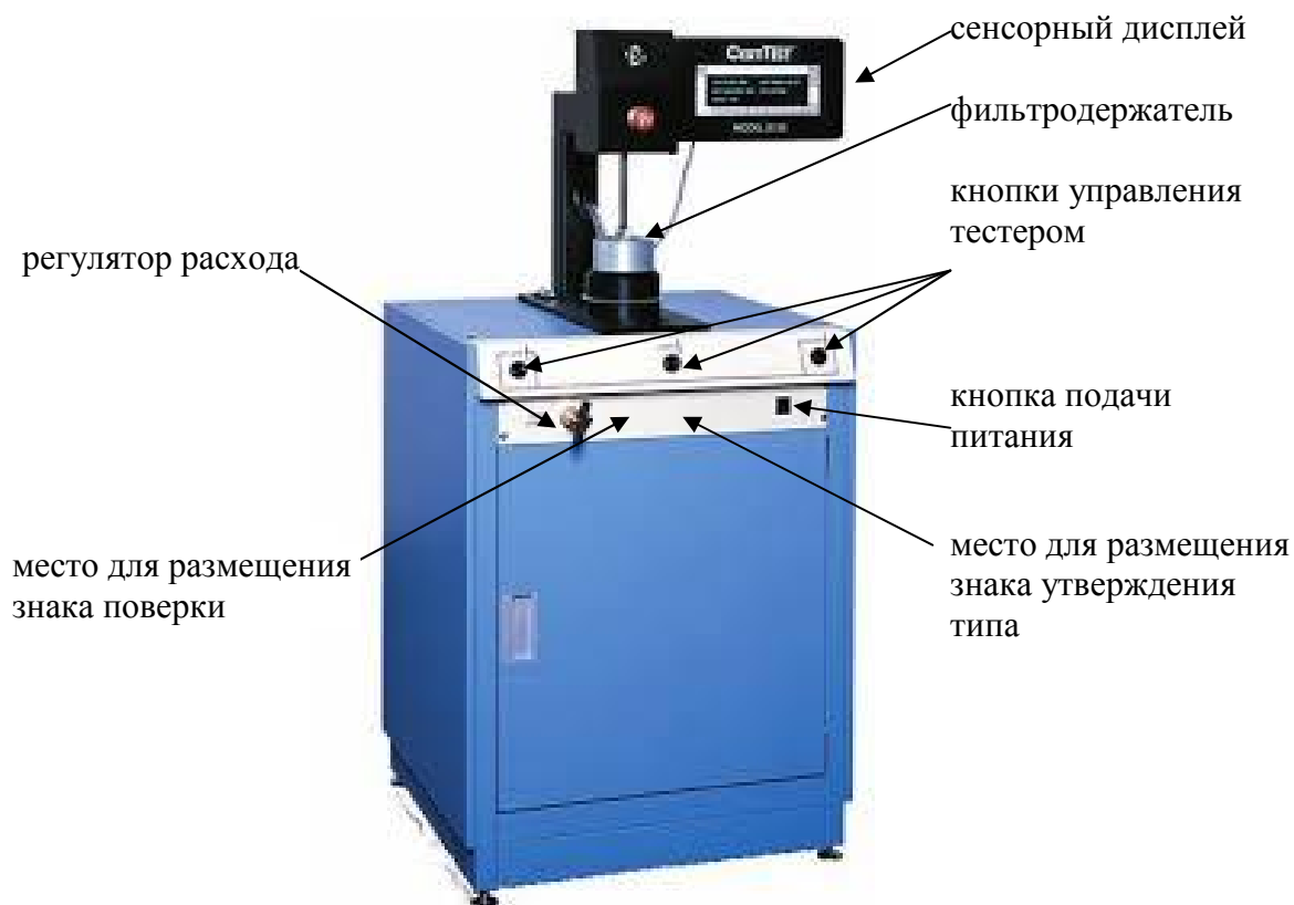
Рисунок 1 - Внешний вид тестеров, обозначение места для размещения знака утверждения типа
