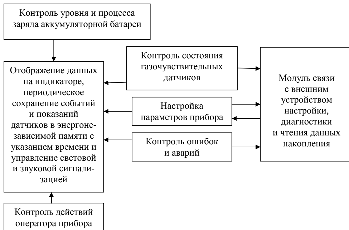
Рисунок 3 - Структура ПО газоанализатора ФПЗЗ
