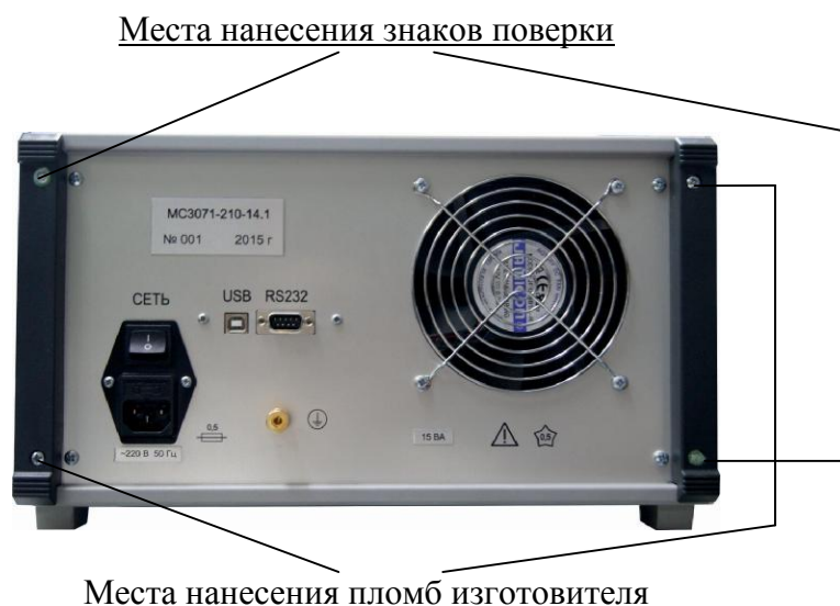
Рисунок 2 - Схема пломбировки от несанкционированного доступа, обозначение мест нанесения знаков поверки
