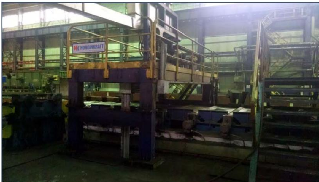
Рисунок 1 - Общий вид установки автоматизированного измерения геометрических параметров листового проката «GEOMETRIX-PL»
