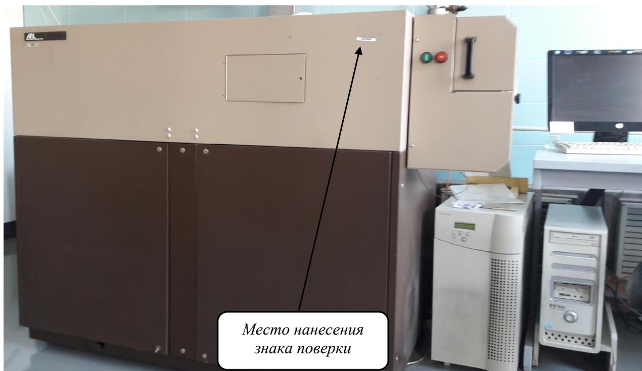
Рисунок 1 - Внешний вид спектрометра
