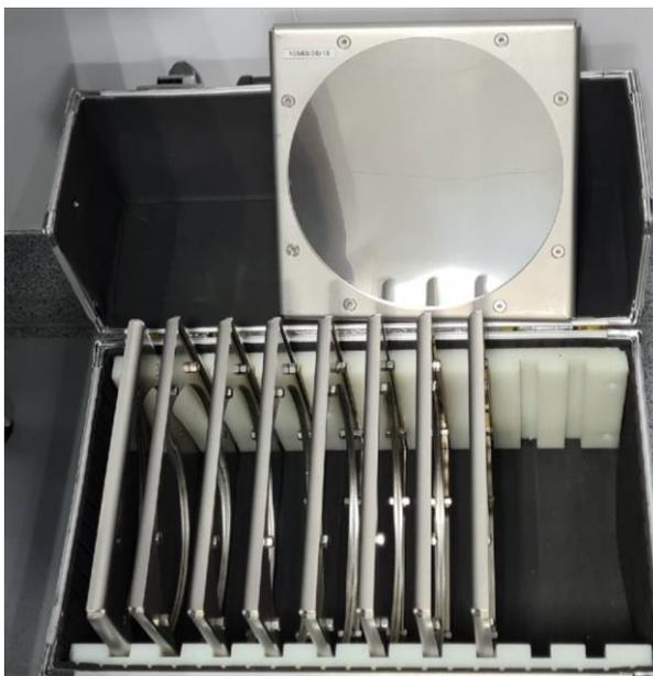
Рисунок 1 - Общий вид комплекта мер толщины TRM-P4-Fe
