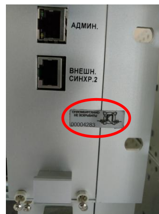
Рисунок 2 - Пломбировочная наклейка на передней панели КС СМК-30
