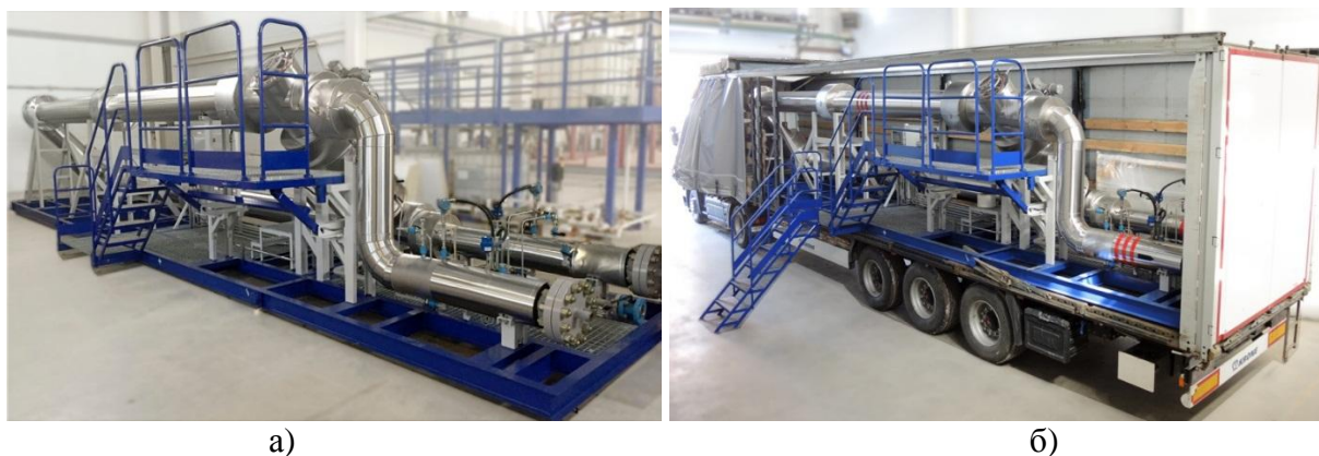
Рисунок 1 - Общий вид установок поверочных трубопоршневых ТПУ ИНКОМСИСТЕМ: а) - стационарное исполнение; б) - передвижное исполнение
