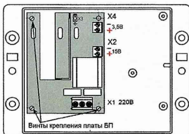
Рис. Н.2 – Схема монтажа БП в корпусе
