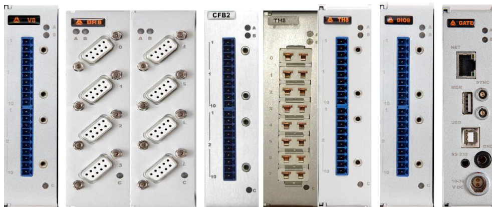
Рисунок 1 - Общий вид передних панелей модулей DS-NET (слева направо: V8, BR8, CFB2, TH8, DIO8, DS-GATE)
