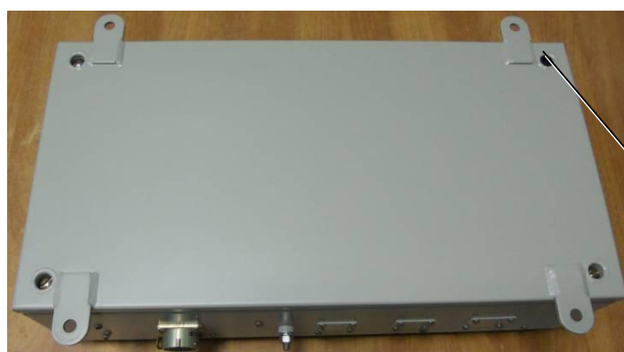
Рисунок 4 - Схема пломбировки он несанкционированного доступа блока БКР-У
