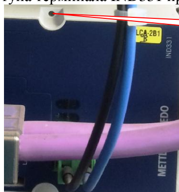
Рисунок 7 - Схема пломбировки от несанкционированного доступа терминала IND331
