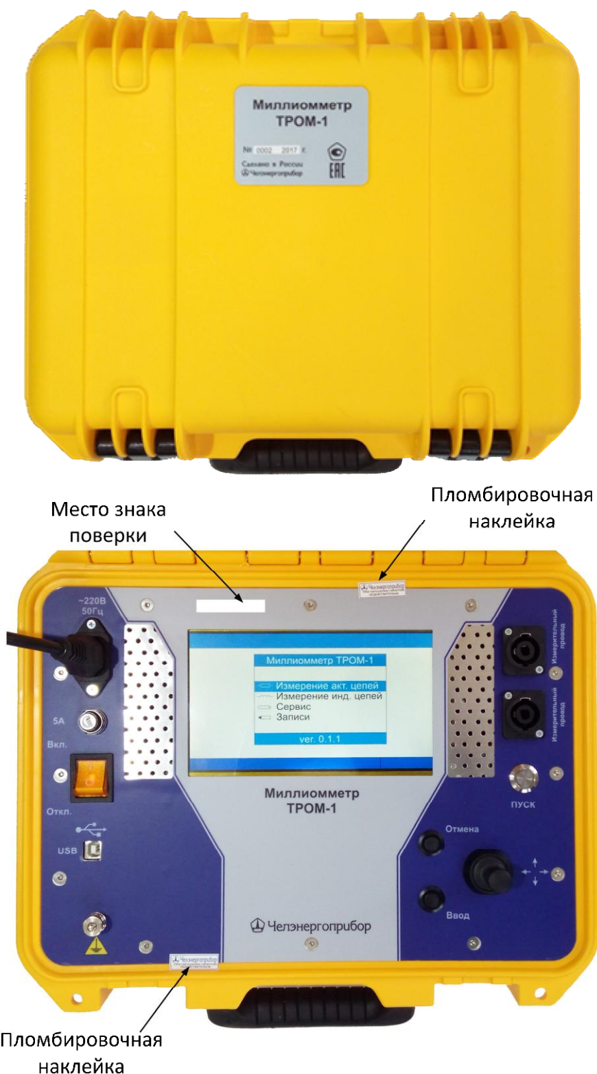
Рисунок 1 - Внешний вид прибора с местами пломбирования и местом нанесения знака поверки
