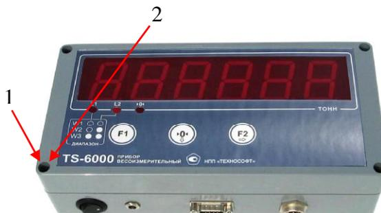
Рисунок 1 - Общий вид приборов. Схема пломбировки
