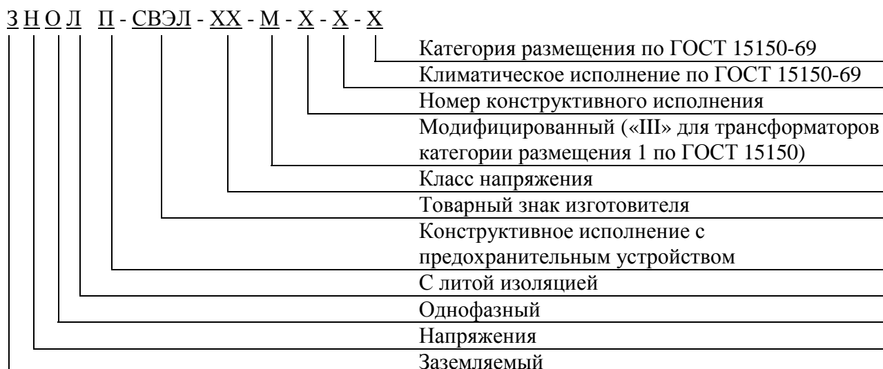
Рисунок 5 - Структура условного обозначения трансформаторов напряжения ЗНОЛ(П)-СВЭЛ
