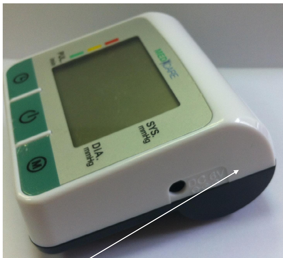
Рисунок 3 – Схема пломбировки от несанкционированного доступа
