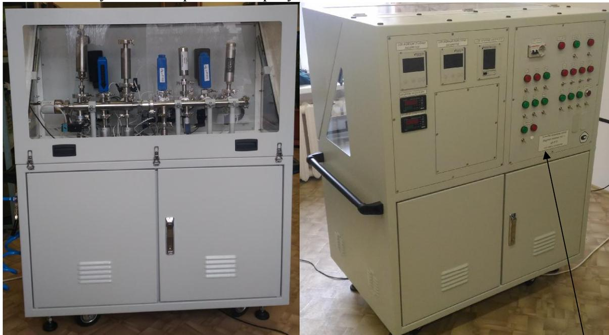
Рисунок 1 – Установка вакуумная потокометрическая эталонная УВПЭ
