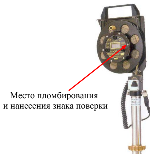
Рисунок 2 - Схема пломбировки от несанкционированного доступа, обозначение места нанесения знака поверки на устройства измерительные IMS-1042
