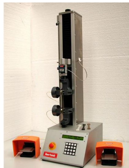
Рисунок 4 - Общий вид машин испытательных электромеханических Eurotest IBTH-1; Eurotest IBTH-3; Eurotest IBTH-5; Eurotest IBTH-10
