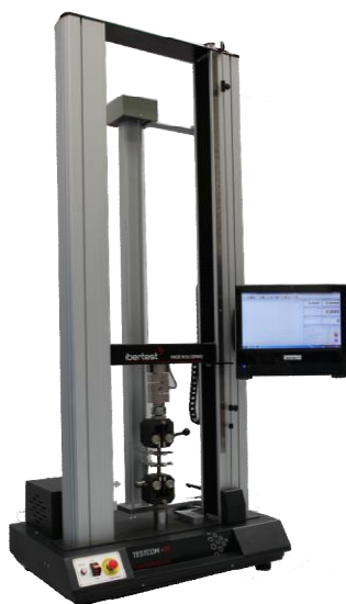
Рисунок 3 - Общий вид машин испытательных электромеханических Eurotest T-0.1; Eurotest T-0.3; Eurotest T-0.5; Eurotest T-1; Eurotest T-3; Eurotest T-5; Eurotest T-10; Eurotest T-20; Eurotest T-30; Eurotest T-50
