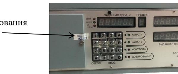
Рисунок 3 – Место пломбирования откидной крышки передней панели БЗД
