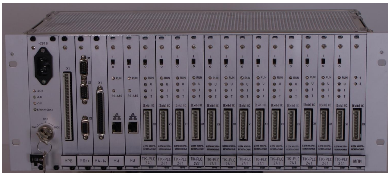
Рисунок 1 – Внешний вид крейта с вспомогательными модулями и контроллерами ТК-PLC
