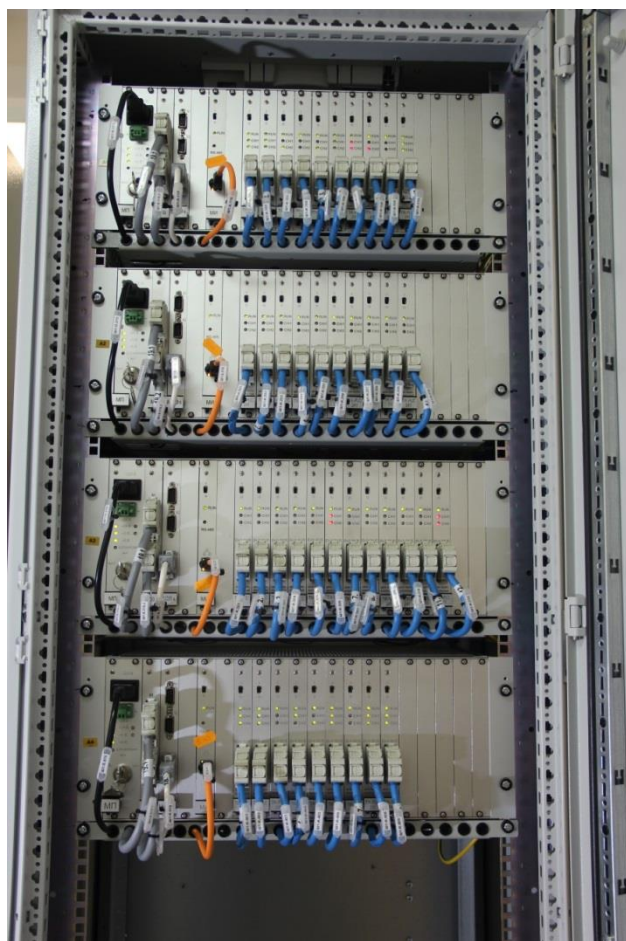
Рисунок 4 - Внешний вид системы информационно-измерительной расширенного вибромониторинга «ТИК-RVM.2» в исполнении 1
