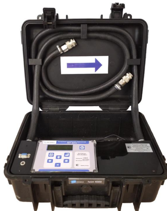
Установки поверочные переносные ТЕСТ ВС модификаций ТЕСТ-ВС/2.3 и ТЕСТ-ВС/2.5
